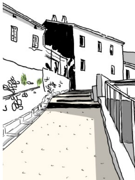
Béton désactivé couleur sable Et caniveau en pierre
