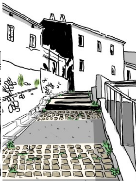
Alternance bande bitumée et pavage Caniveau latéral
