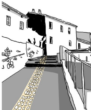
Béton gris et canivea central en pierre
