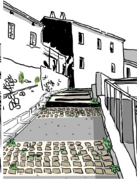
Alternance bande bitumée et pavage Caniveau latéral
